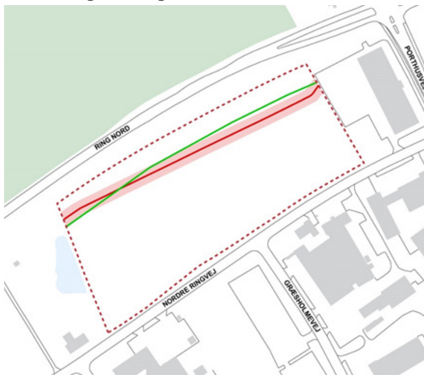
Figur 5 - Illustrationen viser hvilke bindinger der er inden for lokalplanområdet. Den grønne linje er vejbyggelinje afkastet af Ring Nord. Den røde linje er den tinglyste gasledning fra selskabet Evida med respektafstanden på 5 m. markeret med lyserød.
